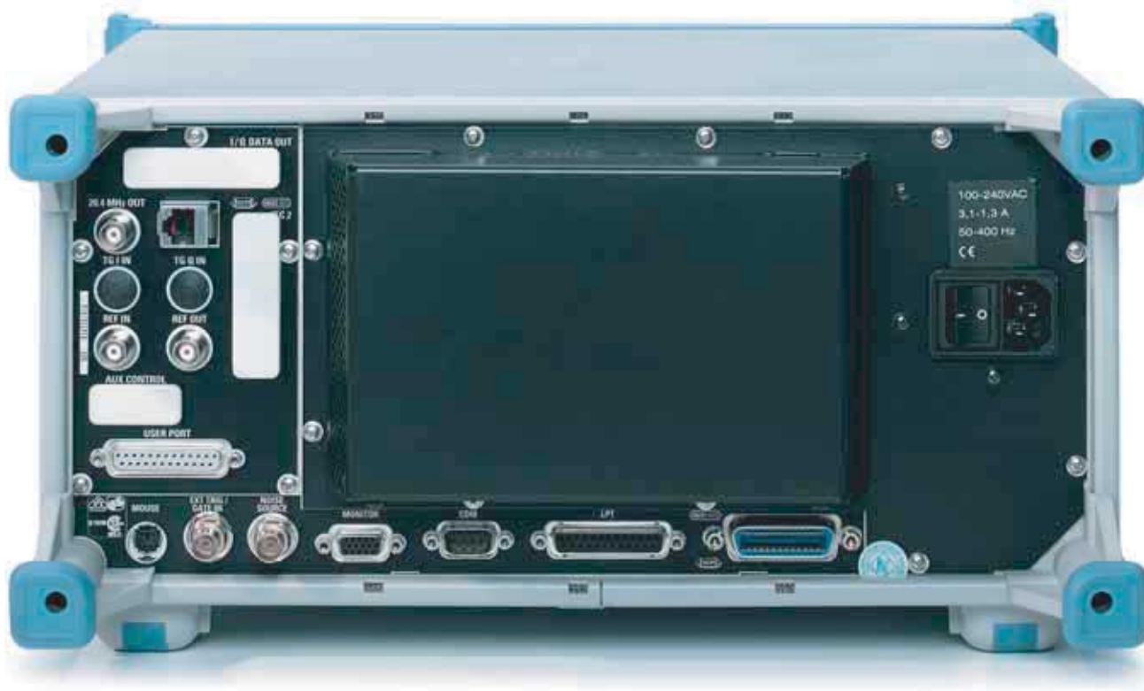
На виде сзади показаны разъемы следящего генератора, порта пользователя, LAN-интерфейса и другие входы и выходы
